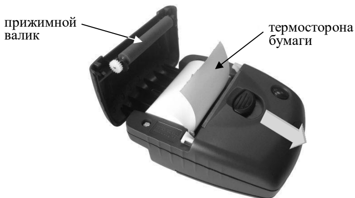
Рисунок 16 – Установка термобумаги в принтер
