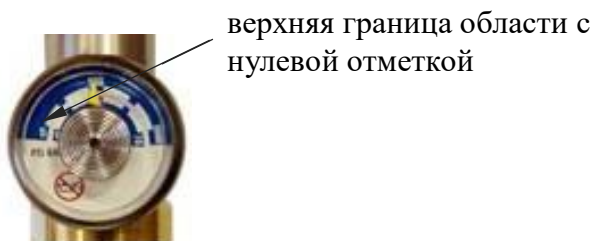
Рисунок 19 – Манометр на редукторе баллона
